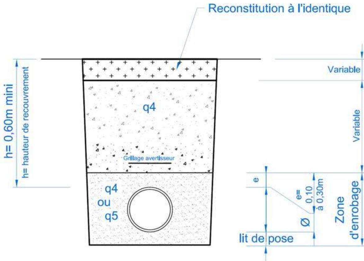
Le remblayage des **tranchées classiques étroites sous chaussée** situées sur le réseau départemental de catégories R0, R1, R2, R3, R4 doit être effectué conformément à la fiche n°6 annexée à la présente autorisation.
